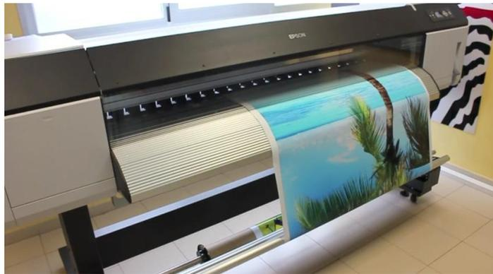
Finalmente cuando la máquina termina se corta el material excedente en los bordes con la barra de corte.
