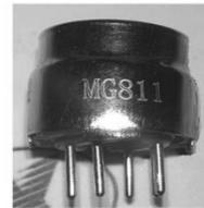
Fig. 4 Sensor de dióxido de carbono MG811
